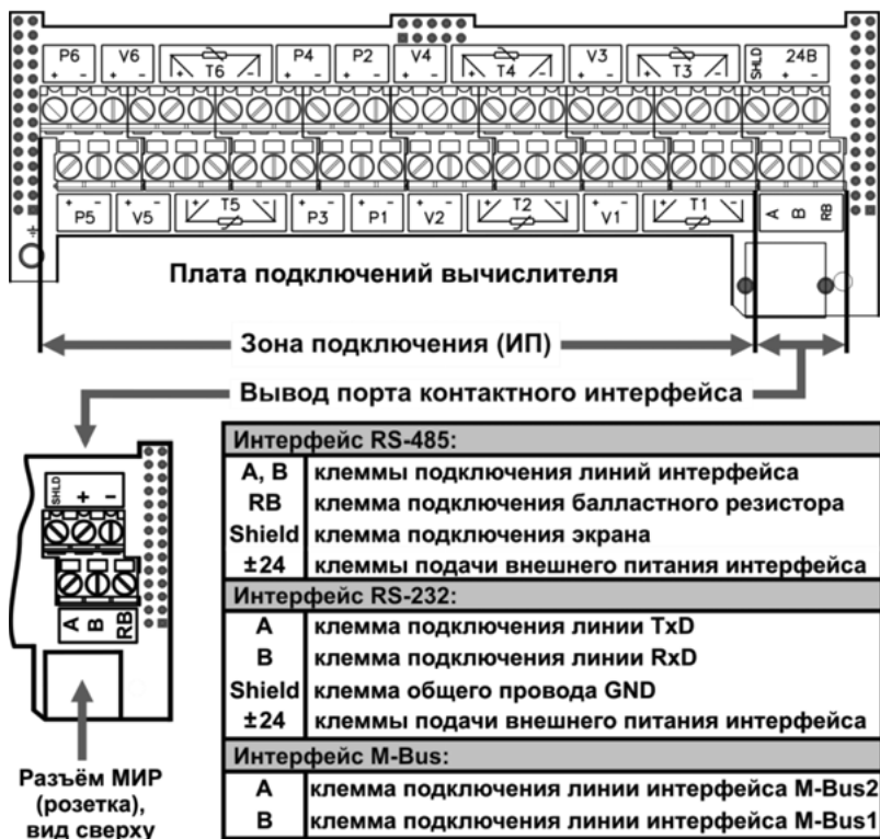
Рисунок 1.7 – Подключение вычислителя к контактным интерфейсам
